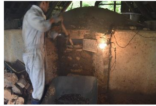
薪をくべて温度を上げていく
